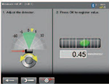
1. 测量垂直值，转动轴使黄色箭头落在绿色区域。
